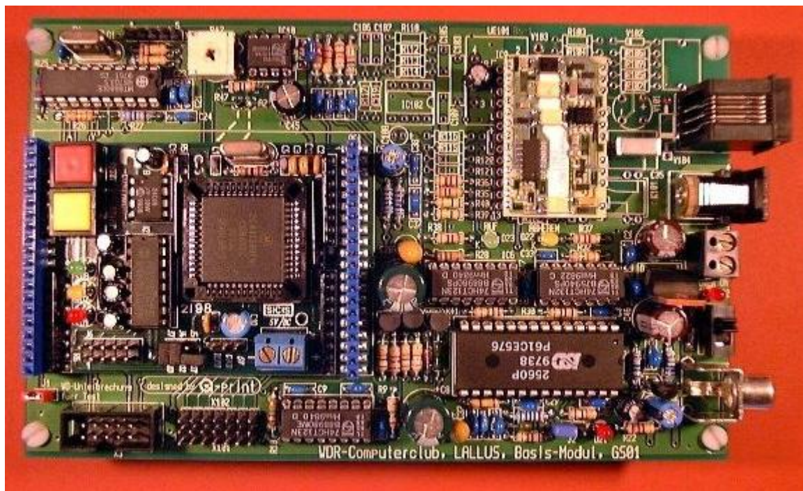
Bild 1 Fertig aufgebautes Grundmodul mit dem Lineinterface MT8842 (Mitel)
